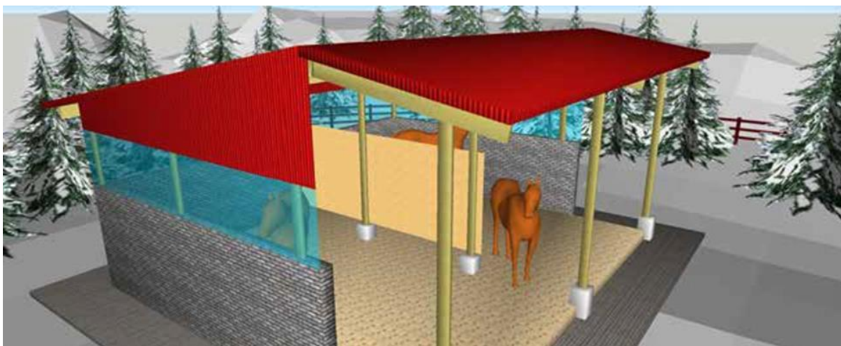
Bild 10. Ett takutsprång längs den öppna långsidan kan verka hindrande för snö- och regninblåst.
