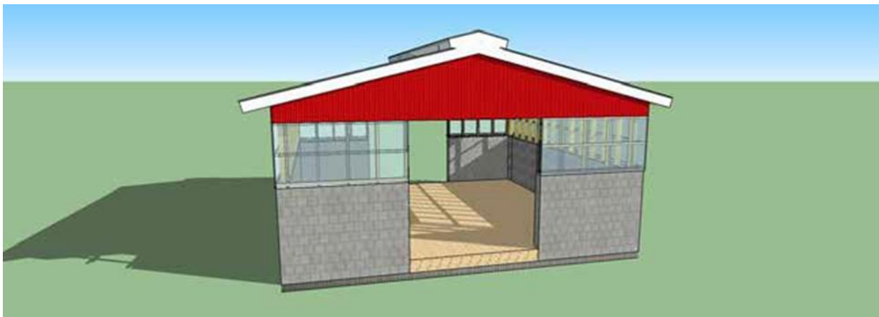
Bild 13. Exempel på dagsljusinsläpp, med ljusgenomsläppligt material i väggar, på en ligghall med sadeltakskonstruktion.
