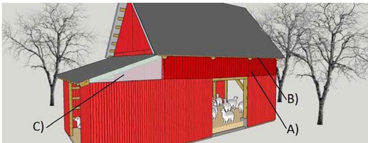
Bild 11. En befintlig lada/loge samt tillbyggt pulpettak där åtgärder vidtagits för att få luftväxling i byggnaden. A) Övre träpanel har glesats ur. B) Luftväxling sker även via öppen takfot. C) Pulpettak är försett med vindgenomsläppligt material i övre delar av gavlar.
